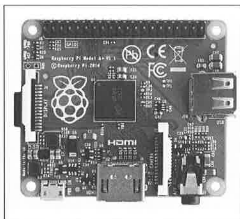
รูปที่ 1-9 บอร์ด Raspberry Pi Model A+ ที่ออกแบบแผ่นวงจรพิมพ์ใหม่ทั้งหมด เพื่อให้มีขนาดเล็กลง
