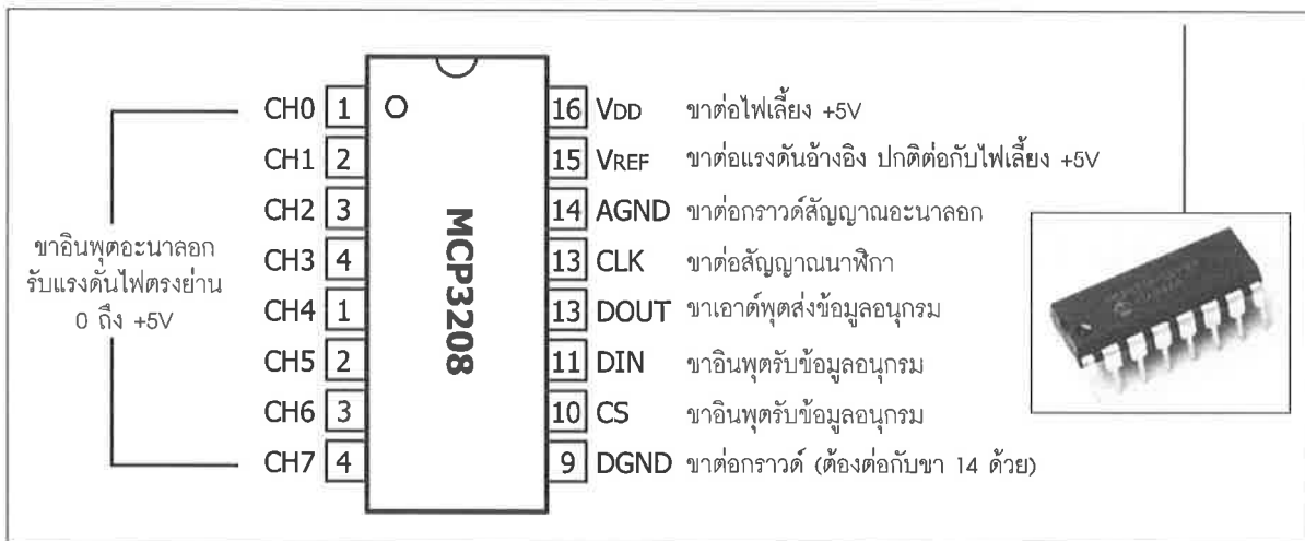
รูปที่ 9-1 การจัดขาของไอซีแปลงสัญญาณอะนาล็อกเป็นดิจิทัลเบอร์ MCP3208
