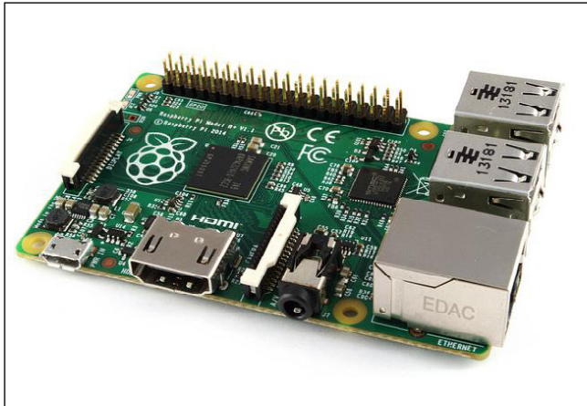
รูปที่ 1-3 บอร์ด Raspberry Pi Model B+ ที่มีการปรับ อย่างมากด้านรูปลักษณ์และจุดต่ออุปกรณ์ภายนอก
